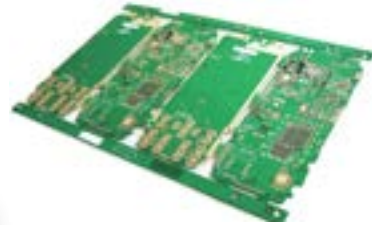
• Laser via through 2 metal layers (8L) HDIサンプル-2層貫通レーザービア (8L)
