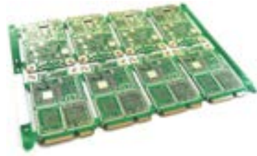
• HDI - Laser via through 3 metal layers (10L) HDIサンプル-3層貫通のレーザービア (10L)
